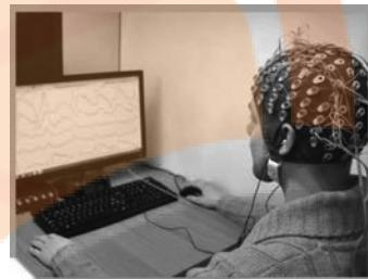
(ب) با توجه به شکل، الکترودها توسط پوشش کلاه مانندی به سر فرد متصل شده‌اند و مستقیماً روی سر قرار نگرفته‌اند.
