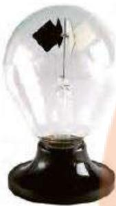
پرتوسنج (رادیومتر) وسیله‌ای است که از یک حباب شیشه‌ای تشکیل شده است که درون آن چهار بره فلزی قائم قرار دارد که می‌توانند حول یک محور (سوزن عمودی) بچرخند. دو وجهه هر چهار بره، یک در میان سفید و سیاه است. وقتی این وسیله کنار یک چشم نور قرار گیرد، پره‌ها حول سوزن عمودی می‌چرخند و هر چه شدت نور بیشتر باشد، این چرخش سریع‌تر است. در مورد دلیل چرخش پره‌ها تحقیق کنید.
