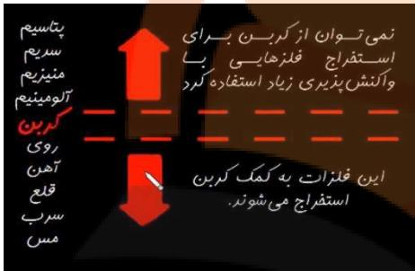
کربن واکنش پذیرتر از آهن است اکسیژن را می‌گیرد تا آهن آزاد شود.
