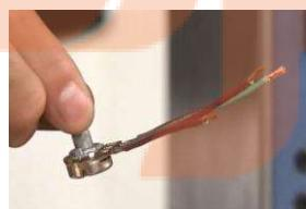
پتانسیومتر (نوعی مقاومت متغیر) ساختار آن با رئوستا یکی است اما پتانسیومتر در بستن مدار کمی با رئوستا
