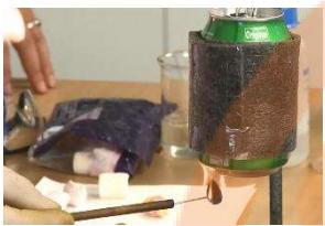
تا جایی که ماده غذایی (مغز بادام) می‌سوزد آن را زیر گرماسنج نگه میدارم تا باعث گرم شدن آن شود (در این آزمایش حدود ۸۹ درجه) اگر دمای آب زیاد شد و مثلاً به بالای ۹۰ درجه رسید
