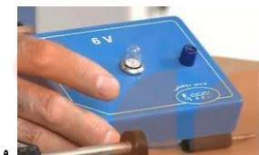
ولتسنج، برای اندازه گیری اختلاف پتانسیل
