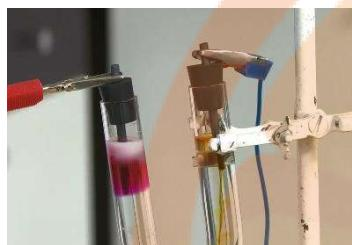
در سمتی از لوله که به قطب منفی لوله متصل است کاهش انجام خواهد شد؛ کاتیون پتاسیم و هیدروژن با هم رقابت می‌کنند و هیدروژن با توجه به جدول الکتروشیمیابی در این رقابت برنده شده کاهش میابد و به صورت گاز خارج می‌شود. به همین خاطر است که باید الکترود را به آرامی در دهانه لوله قرار دهیم تا گاز ایجاد شده به راحتی خارج شود و پرتاب صورت نگیرد. برای اینکه قابل رویت باشد. غلظت  $\text{OH}^-$  افزایش می‌یابد و رنگ ارغوانی یا بنفش ایجاد شده به خاطر خاصیت بازی ناشی از آن است.
