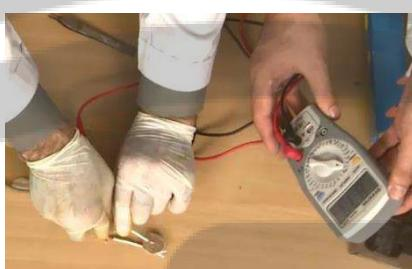
❖ با مولتی‌متر اختلاف پتانسیل دو سر آن را اندازه می‌گیریم. (۰/۸۷۳ ولت) کمی که زمان می‌گذرد ولتاژ کاهش می‌یابد (۰/۷۴۴ ولت) و همچنان این افت ادامه خواهد داشت. این به دلیل مصرف مواد آن است.
