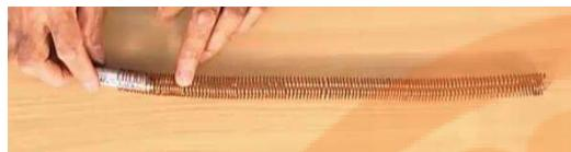
آهنرباها را طوری که قطب‌های هم‌نام آنها به سمت باتری باشد به دو سر باتری وصل می‌کنیم. اگر باتری را از ابتدای سیم‌لوله، درون آن قرار دهیم می‌بینیم که مجموعه باتری-آهنربا به حرکت می‌افتد.
