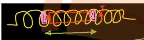
(۱) اگر یک سیم پیچ را در نظر بگیریم که از آن جریان برق عبور می کند و سیم پیچ را آهنربا می کند باتری که به دو سور آن آهنربای قوی نئودیمیوم متصل است و در داخل سیم پیچ قرار می گیرد باعث عبور
