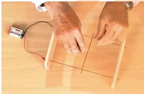
مطابق شکل، بین دو تخته ۱۰ در ۱۰ سانتیمتری، دو میله برنجی یا مسی را به طور موازی بین آنها قرار می دهیم و به صورت افقی نگهداریم. از یک باتری ۹ ولتی که آمپر بیشتری داشته باشد استفاده می کنیم و یا به جای باتری می توان از یک ترانس کاهنده استفاده کرد. ولتاژ ۴ یا ۵ ولت کافی است. یک سیم برنجی حدود ۱۰ تا ۱۲ سانتیمتری را که بتواند روی دو سیم موازی قرار گیرد و آزادانه حرکت کند و روی آنها بغلند تهیه می کنیم. یک آهنربای قوی از نوع نئودیمیوم باشد بهتر است.
