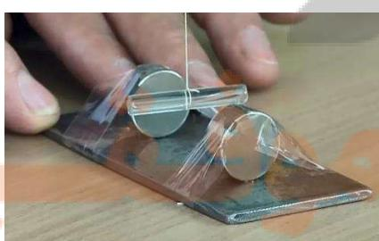
شیشه یک ماده **دیامغناطیس** است که **عمود** بر میدان مغناطیسی قرار می‌گیرد.
