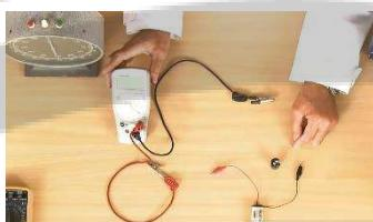
برای اینکه از نحوه شارژ شدن آن آگاه شویم از مولتی متر استفاده می‌کنیم و آن را در قسمت ولت مستقیم قرار می‌دهیم. دو سر مولتی متر را به دو سر خازن وصل می‌کنیم که همزمان در حالی که شارژ می‌شود اختلاف پتانسیل هم داشته باشیم.
