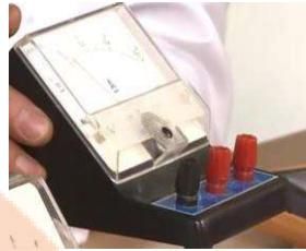
۱۱۰ آمپرسنج و میلی آمپرسنج، برای اندازه‌گیری جریان الکتریکی
