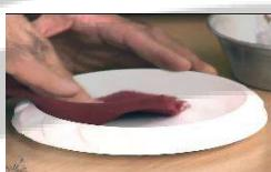
برای باردار کردن الکتروفور یک پارچه پشمی را روی صفحه نارسانا مالش می‌دهیم سپس صفحه رسانا را روی آن قرار می‌دهیم.
