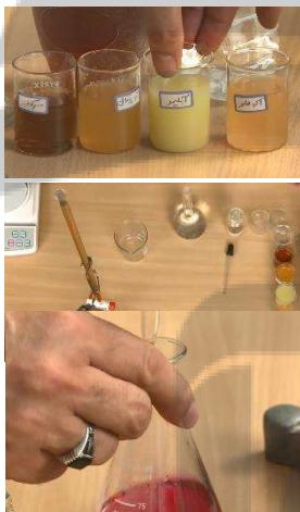
در این آزمایش از وسایل ساده‌ای استفاده شده است بجز بورت که اگر در اختیار نبود می‌توان از قطره‌چکان به جای آن استفاده کرد. می‌شود میزان اسیدی آب میوه‌ها را نیز به دست آورد.
