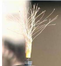
۱. فیش رابط نخ دار را روی کلاهک واندوگراف قرار می دهیم نخها شکل و طرح خاصی ندارند دستگاه را روشن می کنیم می بینیم که نخ ها برافراشته شده به صورتی که خطوط میدان الکتریکی را که به صورت نقطه ای است نشان می دهند.
