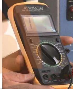
مولتی‌متر یا چند کاره، در دو نوع عقربه‌ای و دیجیتالی موجود است کلید بزرگ وسطی آن کلید انتخاب گر یا سلکتور نام دارد که با چرخش آن می‌توان هر کمیت را برای اندازه‌گیری انتخاب کرد. معمولاً این ۴ کمیت را همه دارند:
