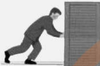
در شکل نشان داده شده، شخص با نیروی  $200\text{ N}$  جسم  $90\text{ کیلوگرمی را هُل می‌دهد$ ، اما جسم ساکن می‌ماند. ولی وقتی با نیروی  $300\text{ N}$  جسم را هُل می‌دهد، جسم در آستانه حرکت قرار می‌گیرد.
