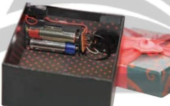
شکل ۲-۲۸—جانمایی مدار پروژه و کلید
