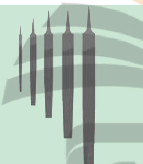
شکل ۱۳-۱- انواع سوهان در اندازه‌های متفاوت
