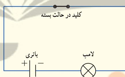
شکل ۱۱-۲- مدار بسته
