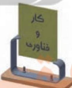
شکل ۱-۳۹- متصل کردن قطعات با پیچ و مهره
