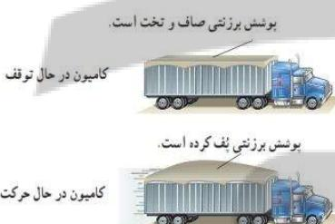
با حرکت کامیون، تندی جریان هوا در بالای پوشش برزنتی افزایش یافته و طبق اصل برنولی فشار هوا در آن قسمت کاهش می‌یابد، در نتیجه اختلاف فشار هوای داخل و بیرون پوشش برزنتی باعث پُف کردن آن می‌شود.
