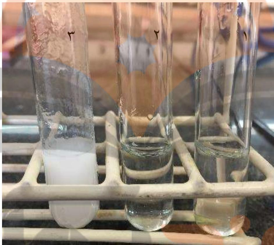
لوله آزمایش شماره ۱ حاوی محلول سدیم فسفات، لوله آزمایش شماره ۲ حاوی محلول کلسیم کلرید و لوله آزمایش شماره ۳ حاوی رسوب کلسیم فسفات.
