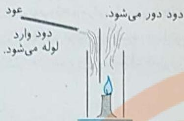
از یک طرف تیغه فلزی دود از لوله شیشه‌ای دور می‌شود و از طرف دیگر تیغه فلزی دود به درون لوله کشیده می‌شود.
