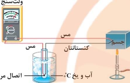
ب) کمیت دماسنجدی این دماسنجد، جریان الکتریکی است.
