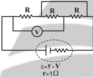
۵۰- در مدار شکل زیر، به ترتیب از راست به چپ،  $R_1$  چند اهم باشد تا توان مصرفی مقاومت‌های خارجی مدار بیشینه شود و در این صورت
