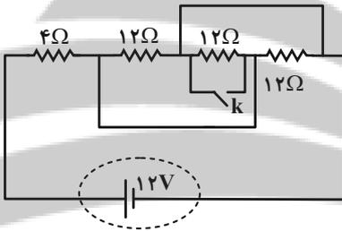
۵۳- در مدار شکل زیر، اگر کلید  $k$  را ببندیم، جریان عبوری از مقاومت ۲ اهمی چگونه تغییر می‌کند؟
