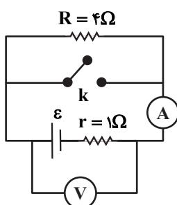
۸۵- در شکل زیر، اگر کلید k بسته باشد، آمپرسنج آرمانی عدد ۱۰A را نشان می‌دهد. اگر کلید k باز باشد، توان خروجی مولد در این حالت چند وات است؟
