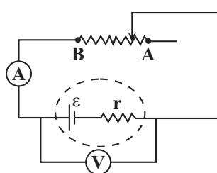
۱۰۵- در مدار شکل زیر، با حرکت لغزنده رئوستا از نقطه A تا نقطه B، اعدادی که آمپرسنج آرمانی و ولتسنج آرمانی نشان می‌دهند، به ترتیب از راست به چپ چگونه تغییر می‌کنند؟
