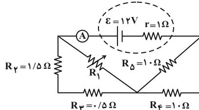
$R_{2,3} = R_2 + R_3 = 1/5 + 0/5 = 2\Omega$  و  $R_4$  و  $R_2$  متواالی هستند.
