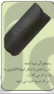
- رسانایی الکتریکی کمی دارد. - در واکنش با دیگر اتمها الکترون نه اشتراک می گذارد. - شکننده است و در اثر ضربه خرد می شود.
