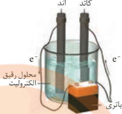
شکل ۱- تجزیه آب به عنصرهای سازنده آن با مصرف انرژی الکتریکی
