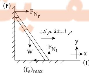
۹ قدم اول: می‌دانیم اگر بین دو سطح اصطکاکی وجود نداشته باشد، تنها نیرویی که به واسطه تماس دو سطح مشاهده می‌کنیم نیروی  $\vec{F}_N$  که عمود بر سطح تماس دو سطح است می‌باشد. بنابراین بین نردبان و دیوار قائم فقط نیروی  $\vec{F}_{N_2}$  را که عمود بر دیوار است را در نظر می‌گیریم؛ اما در سطح افق اصطکاک هم داریم:
