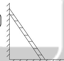
۱۰ نردبانی به وزن  $30\text{ N}$  مطابق شکل زیر بر روی سطح افقی زمین قرار داشته و به دیوار قائم تکیه داده شده است. جسم در آستانه لغزش بر سطح افقی زمین می‌باشد. نیروی اصطکاک بین نردبان و دیوار قائم ناچیز است. اگر بزرگی نیروی واردہ از طرف سطح دیوار بر نردبان  $60\text{ N}$  باشد، ضریب اصطکاک ایستایی بین نردبان و سطح افقی را بیابید.
