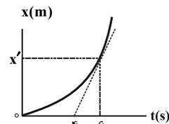
شیب خط مماس بر نمودار مکان - زمان در هر لحظه برابر با سرعت متحرک در آن لحظه است. بنابراین اگر فرض کنیم مکان متحرک در لحظه  $t = 6s$  برابر با  $x'$  باشد، سرعت در لحظه  $t = 6s$  برابر است با:
