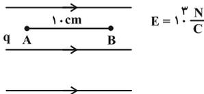
با حرکت در جهت خط‌های میدان الکتریکی، پتانسیل الکتریکی کاهش خواهد یافت. بنابراین  $V_B < V_A$  خواهد بود.
