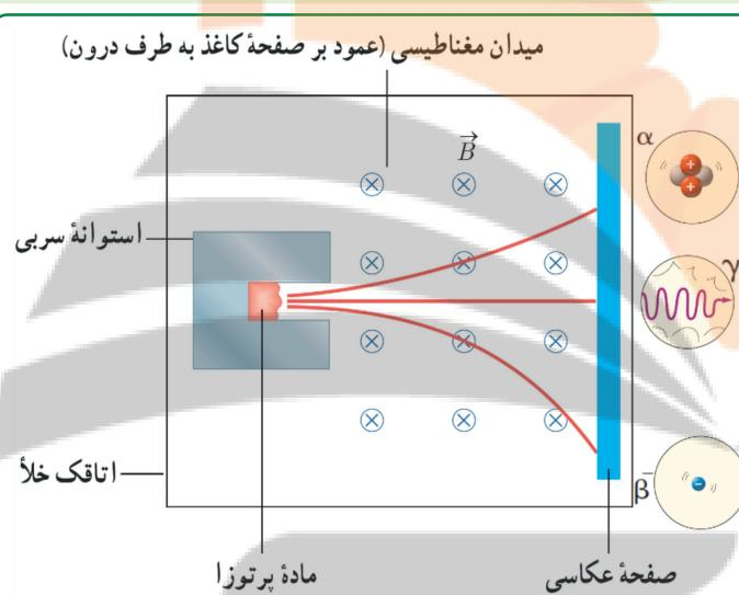
ذره آلفا دارای بار مثبت است بنابراین بر اساس چهت میدان مغناطیسی به سمت بالا خم می‌شود، از طرفی این ذره به دلیل سنگین‌تر بودن نسبت به پوزیترون خمیدگی کمتری دارد. پرتویی که در میدان خم نمی‌شود پرتوی گاما است. این پرتو از دسته امواج الکترومغناطیسی بوده و قادر بار است، بنابراین در میدان الکتریکی یا مغناطیسی تغییر جهت نمی‌دهد. پرتویی که بیشترین خمیدگی را دارد، جرم کمی دارد و از آنجا که به سمت پایین خم شده است، طبق قاعدة دست راست، باید دارای بار منفی باشد، بنابراین الکترون بوده و پرتوی بتای منفی است.
