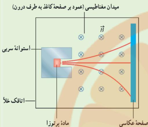
شکل رو برو طرح آزمایش ساده‌ای را نشان می‌دهد که به کمک آن می‌توان سه نوع پرتوزایی طبیعی را مشاهده کرد و به تفاوت بار و جرم پرتوها از یکدیگر پی برد. قطعه‌ای از ماده پرتوزا را در ته حفره باریکی در یک استوانه سربی قوار می‌دهند. استوانه را درون اتاقکی می‌گذارند و هوای درون آن را تخلیه می‌کنند. سپس یک صفحه عکاسی مقابل حفره قرار می‌دهند و میدان مغناطیسی یکنواختی درون اتاقک برقرار می‌کنند. خطوط سیاه رنگ، مسیر حرکت پرتوها را نشان می‌دهد. نوع بار پرتوها را با هم مقایسه کنید.
