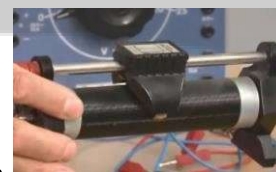
رئوستا یا مقاومت متغیر، معمولاً به طور متوالی در مدار قرار می‌گیرد
